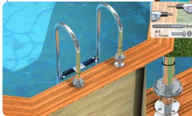
► Bauen Sie die einzelnen Komponenten der Edelstahl-Leiter anhand beiliegender Montageanleitung zusammen. Vergessen Sie bei der Montage der Griffbögen die beiden Gummidichtungen nicht, da diese die dekorativen Verankerungsblenden an Ort und Stelle halten sollen.
