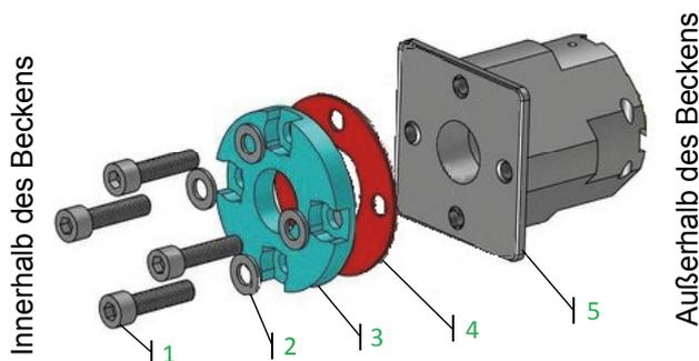
Abbildung 35 – Montage des Flansches für die Wanddurchführung
