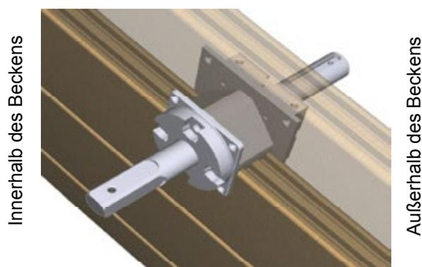
Abbildung 38 – Montage der Welle an der automatischen Abdeckung
