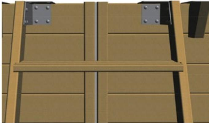
Abbildung 16 – Anbringen der Außenterrappe am Becken
