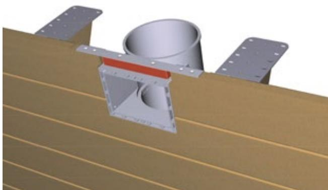
Abbildung 22 – Montage des Winkels am Skimmer
