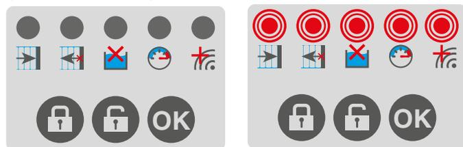
Wenn die 5 LEDs blinken, drücken Sie 1 Sekunde lang die OK-Taste. Beide linke LEDs leuchten
