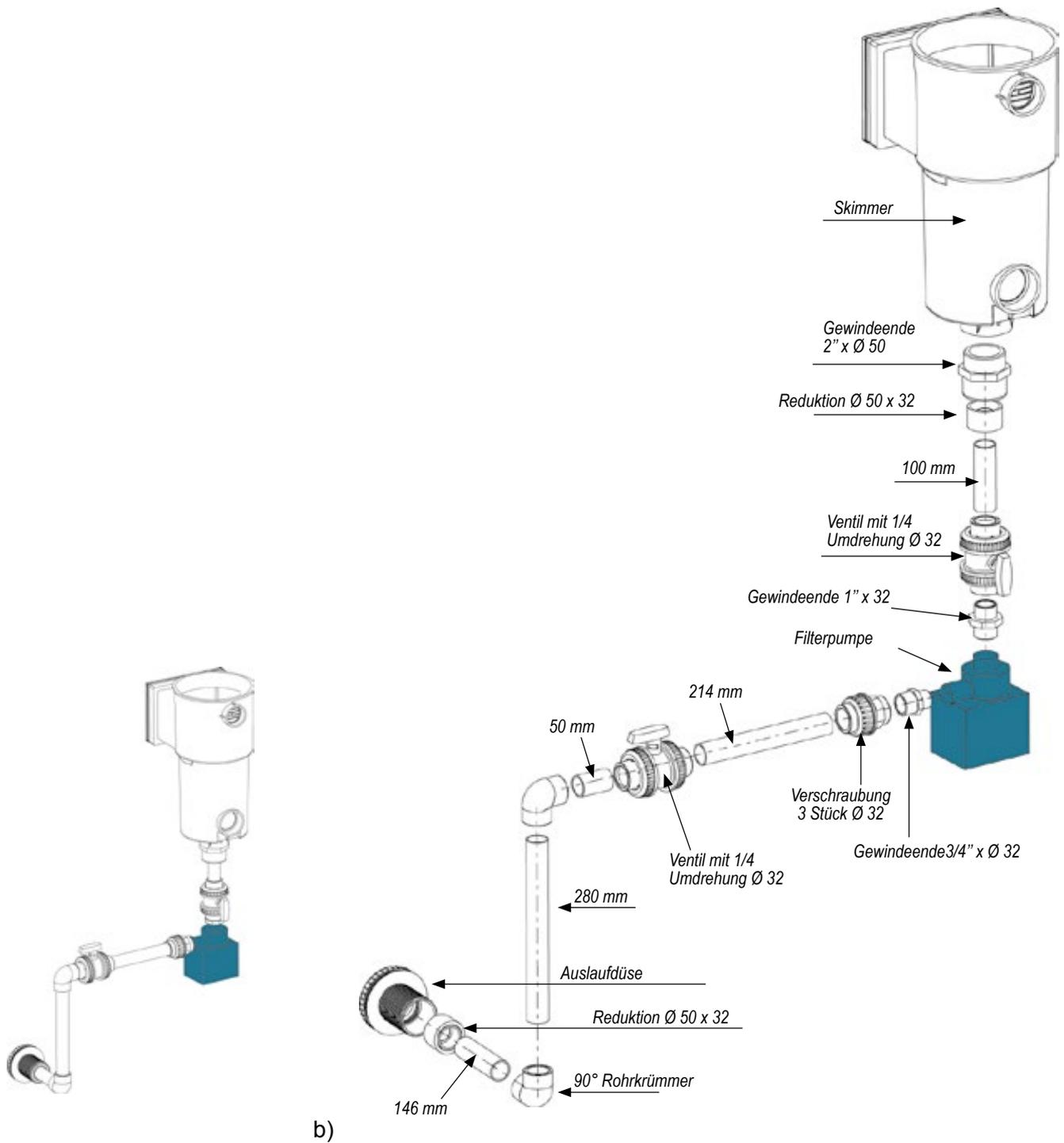
Abbildung 24 – a und b Rohrleitungen für die Filtration
