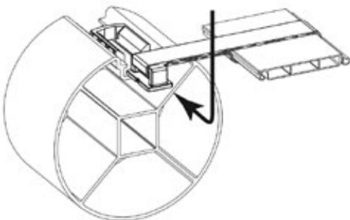
Abbildung 45 – Verbindung von Rollabdeckung und Achse
