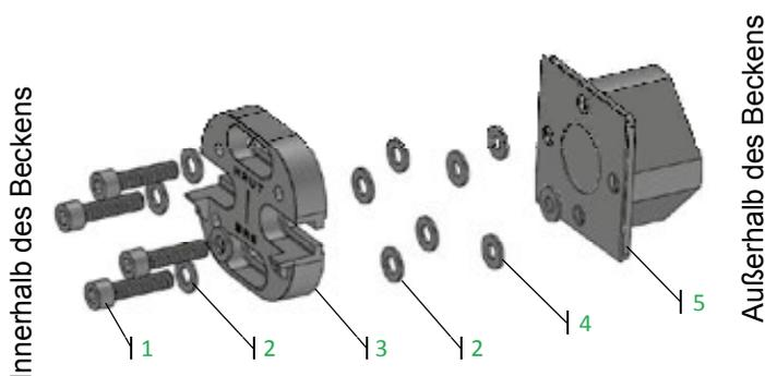
Abbildung 36 – Montage des Flansches mit Lager
