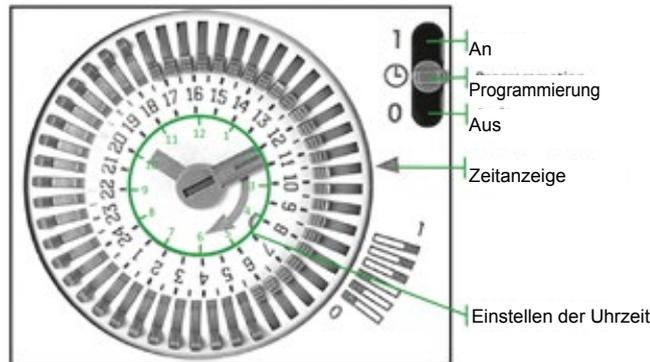
Abbildung 57 – Vorderseite der Uhr der Filteranlage
