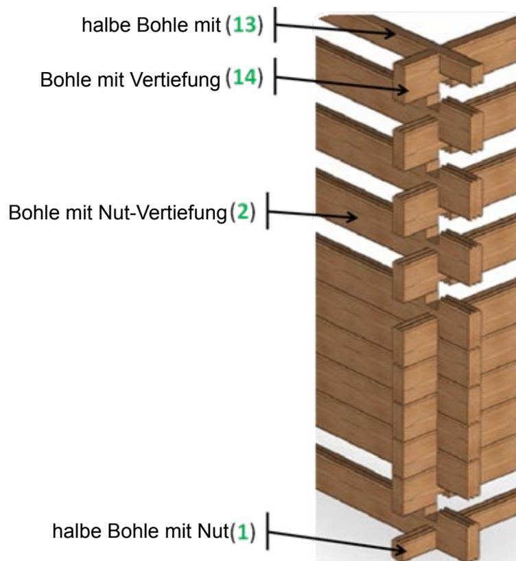
Abbildung 9 – Prinzip der Verkantung der Holzbohlen
